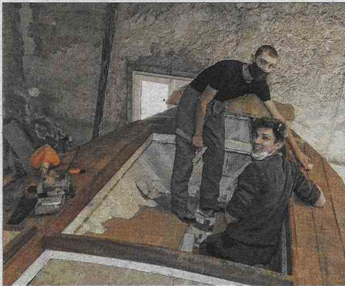
Jimmy et Tom collaborent pour aménager l'intérieur du Pépito en utilisant du ipé, un bois exotique très dur, gras et aux fortes capacités d'étanchéité et d'imputrescibilité.
